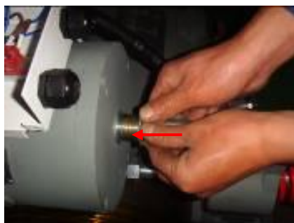
图 3 柱塞的灵活度检查
