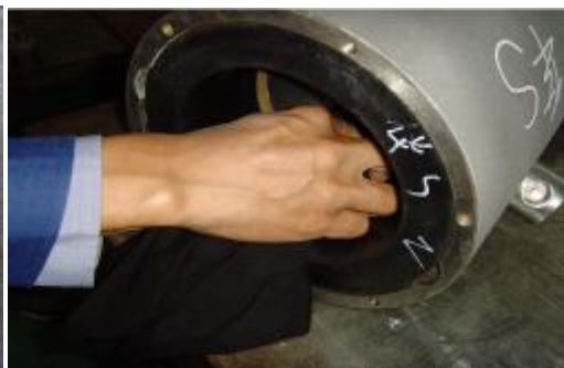
图 6 清理制动器内部
