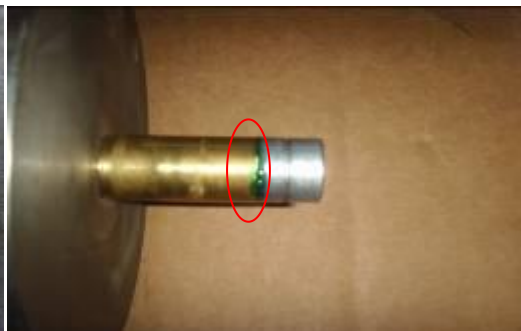
图 10 胶水溢出示意图
